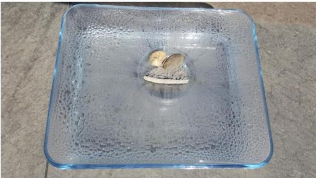
**2** On voit de l'eau apparaître sur le film plastique. L'eau coule vers le verre car il ya un poids au dessus qui crée une pente. L'eau s'est évaporée avec la chaleur. En touchant le film plastique elle se liquéfie. Le sel ne s'évapore pas il reste dans le récipient. L'eau du verre n'est pas salée.
