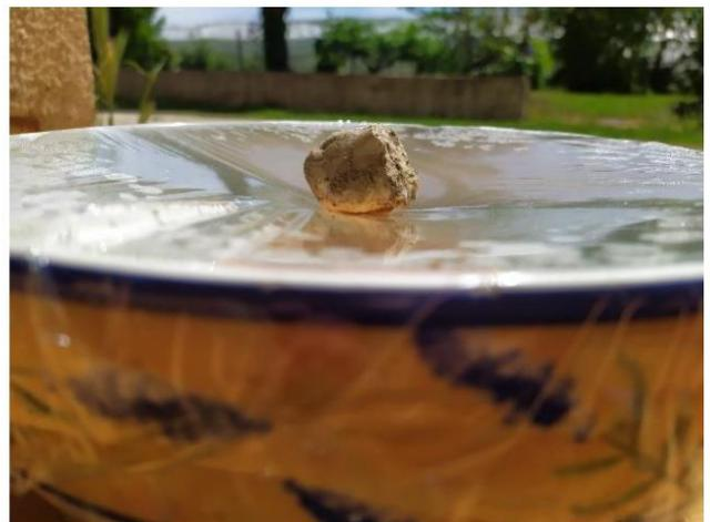
L'eau de mer liquide va s'évaporer puis elle va se condenser sur le papier cellophane et elle va couler en direction du caillou. Les petites gouttelettes vont se rassembler au-dessous du caillou et elles vont faire du goutte à goutte dans le ramequin. A la fin de l'expérience, l'eau se trouvant dans le ramequin ne contient plus de sel donc l'eau est douce, le sel ne s'est pas évaporé avec l'eau.
