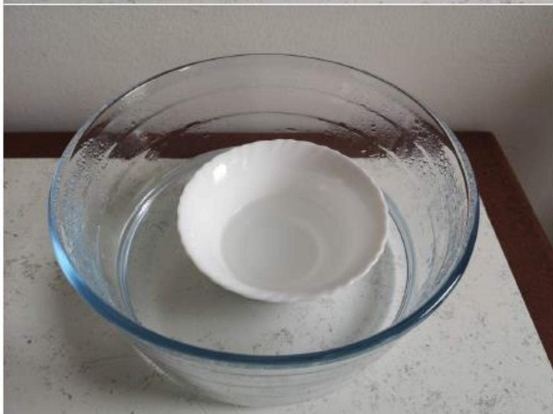
L'eau de mer va se réchauffer et se transforme en vapeur d'eau qu'on appelle vaporisation par la chaleur du soleil. Ensuite la vapeur est bloquée par le film plastique et redevient de l'eau liquide donc elle subit une liquéfaction. Puis les gouttes d'eau coulent dans le bol, où on obtient de l'eau « distillée » qui n'est pas salée. Donc le sel est resté dans le saladier.
